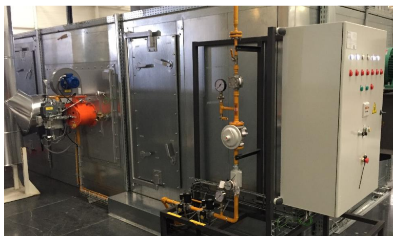
Équipement TORCH'AIRNOX destiné à une ETUVE dans l'INDUSTRIE AUTOMOBILE Avec son foyer échangeur air/air de gamme industrielle
